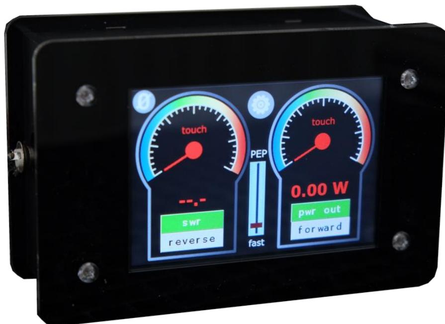
Dieses Gerät wurde als SWR- und Power-Meter, für Funkamateure konzipiert. Es zeigt neben dem SWR auch die vor- und die rücklaufende Leistung an und kann somit auch als Wattmeter verwendet werden. Mit dem großen Messbereich von 1 bis 1000 Watt ist es von QRP bis QRO geeignet. Eine Umschaltmöglichkeit auf dbm Anzeige ist ab Vers 9 eingebaut und ein SWR-Alarm ab Vers9.5
